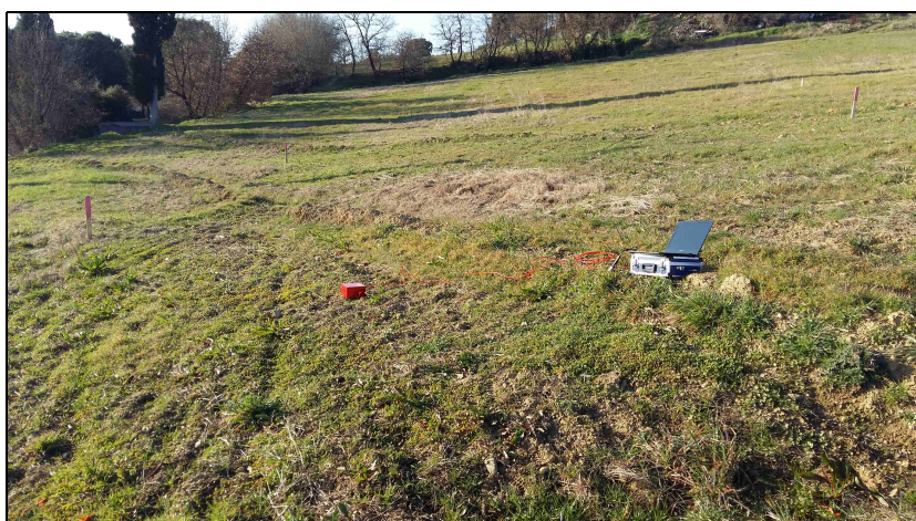
Immagine relativa al punto in cui è stata effettuata la registrazione mediante Geobox (indagine HVSR).
