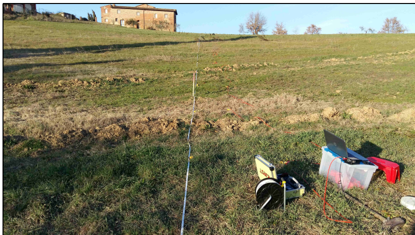
Immagine relativa allo stendimento st2 - sismica a rifrazione in onde P (punto di presa dal geofono 1).
